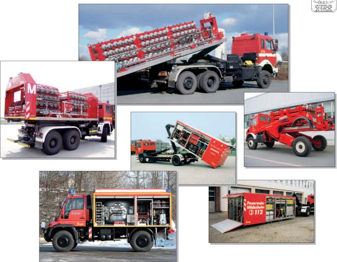
Für den Bereich der Feuerlöschsysteme zum Einbau in Feuerwehr- oder sonstige Einsatzfahrzeuge bietet GLORIA ein umfassendes Lieferprogramm - von Löschanlagenkomponenten bis hin zur betriebsbereiten Löschanlage. Die Montage kann wahlweise auf Auszugrahmen oder Fahrgestellen, sowie im stationären Einbau in Fahrzeugen oder Abrollcontainern erfolgen.
